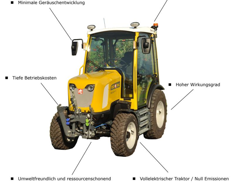
Batterie Lithium-Ionen Spannung 400 V Reichweite Kapazität 58 kWh Reichweite 4-8 h Ladeleistung Ladegerät mit max. 22 kW Ladezeit 80% in 2 Stunden
