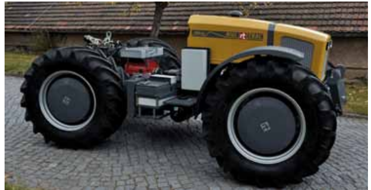
RigiTrac EWD 120 ohne Fahrerkabine: Generator mit Bremswiderstand (rot und silber); Leistungselektronik (grau)
