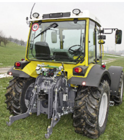
Im Heck ist der Rigitrac mit einem Standardschlepper vergleichbar. Auf dem linken Kotflügel finden sich die Bedienelemente für Hubwerk, Zapfwelle und ein Steuergerät.
