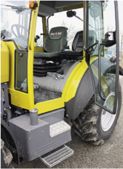
Der Einstieg ist geräumig, und links vom Fahrer gibt es auch einen ordentlichen Beifahrersitz. Der Dieseltank aus Stahl fasst 100 l.
