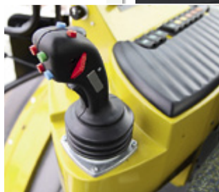
Über diesen Joystick bedienen Sie die vier Hydraulikventile, die Wendeschaltung und – bei Bedarf – die Hinterradlenkung.
