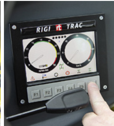
Trotz der kompakten Bauweise ist in der Kabine ausreichend Platz. Der kleine Fahrhebel sitzt neben dem Joystick für die Hydraulikbedienung. Das Farbdisplay rechts unterm Lenkrad hat sechs Funktionstasten für die Programmierung.
