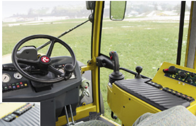
Trotz der kompakten Bauweise ist in der Kabine ausreichend Platz. Der kleine Fahrhebel sitzt neben dem Joystick für die Hydraulikbedienung. Das Farbdisplay rechts unterm Lenkrad hat sechs Funktionstasten für die Programmierung.
