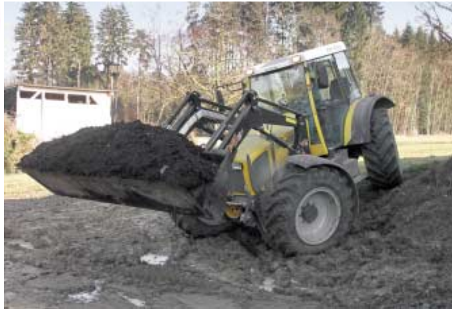
Auch in extremer Schräglage mit eingeschlagenen Rädern, Frontlader und schwerer Siloballe oder Schaufel mit Erde ist zusätzlicher Ballast am Fahrzeugheck nicht erforderlich.
